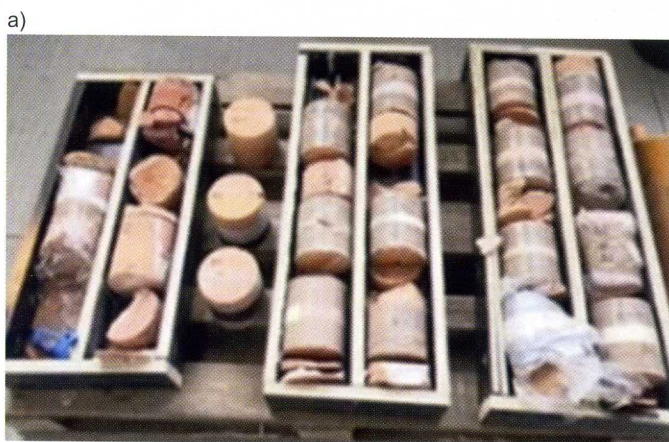
Rys. 9. Przykłady badań materiałowych i wykonanych analiz wiaduktu sprzed rewitalizacji: a) pobrane próbki materiałowe (badania 16.07-14.08.2020 r.) [7], b) wizualizacja modelu obliczeniowego odtwarzającego historię obciążenia do chwili odkopania sklepień [8]
